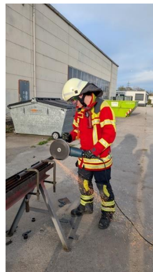
Trennen mittels Winkel- schleifer Foto: Privat
